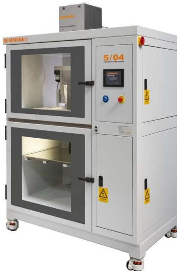
Il sistema di colata sottovuoto 5/04, comprende 2 forni LC/CD e OV/4ST, il modulo per le colate in nylon ed il banco aspira polveri. Consente di produrre prototipi in plastica, cera, silicone e nylon.
