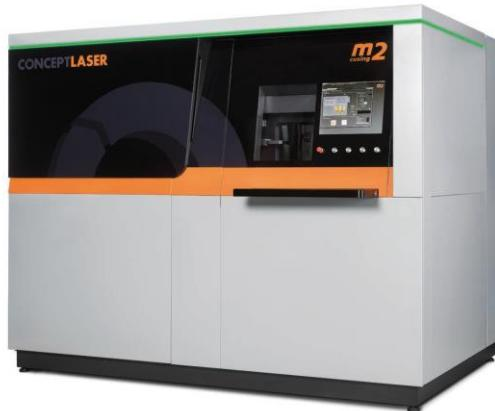
Il sistema M2 Cusing permette di processare materiali metallici reattivi e non reattivi sotto forma di polvere, con la tecnologia LaserCusing® compresi gli utilizzi secondo la normativa ATEX Linea guida II per materiali infiammabili o esplosivi, attraverso una camera di lavoro sigillata che in caso di rottura permette di terminare il lavoro senza un sistema antincendio.
